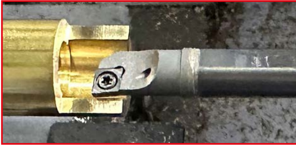
Barre carbure pour le décolletage Diamètre de passage minimum 9 mm
